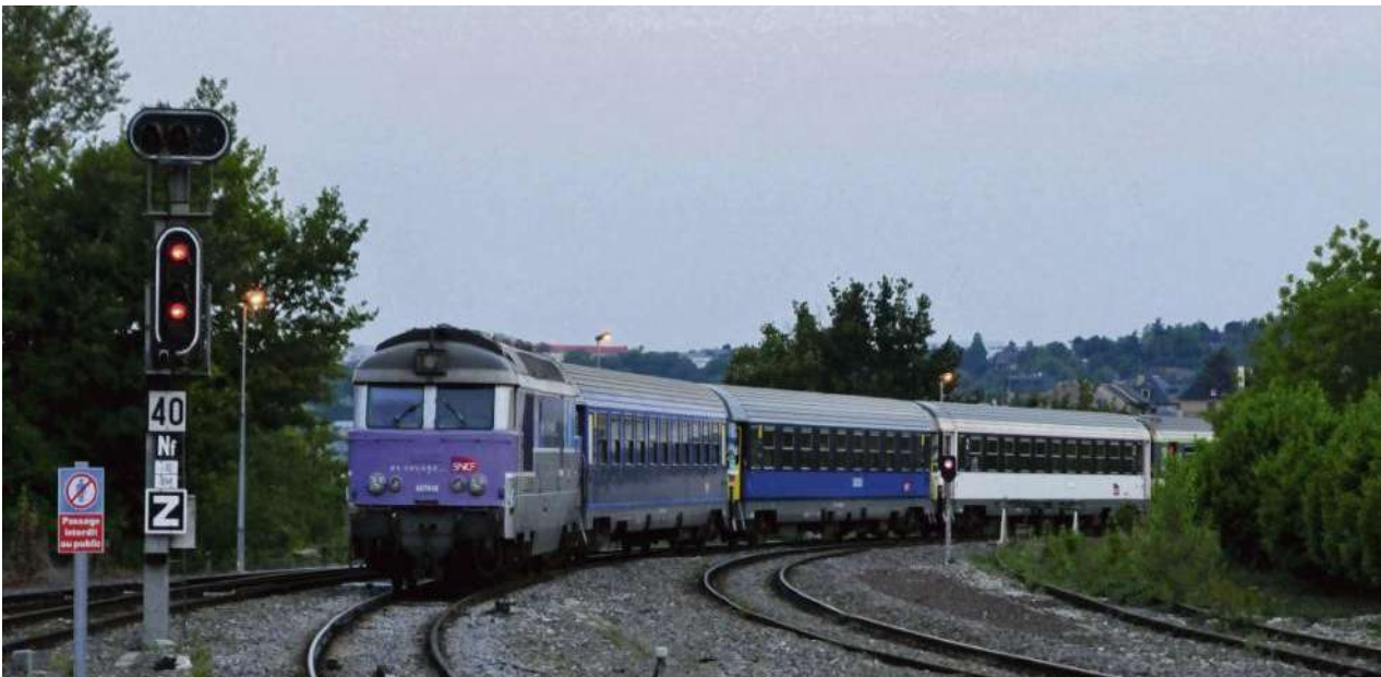
L'intercités de nuit Paris-Rodez entre en gare en traction thermique avec une locomotive diesel de type 67400 des années 1970...
